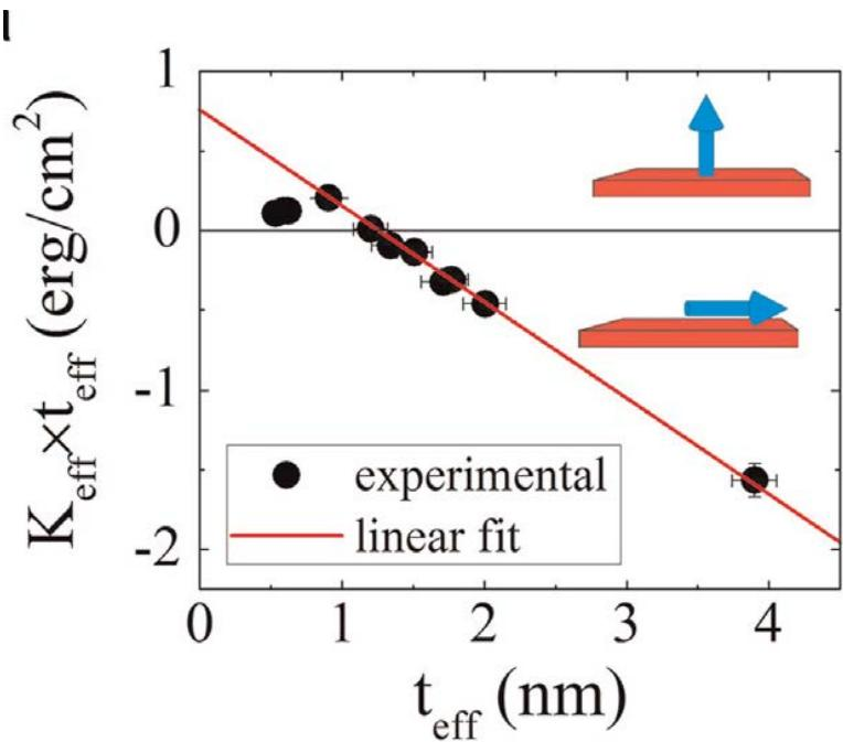
Pentru filme cu **grosimi inferioare la 1 nm** magnetizarea se orientează spontan perpendicular la planul filmului.
